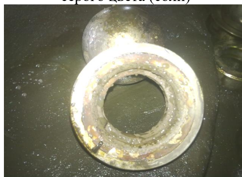
Рисунок 4 Твердые вещества серого цвета (соли) на внутренней полости цилиндра
